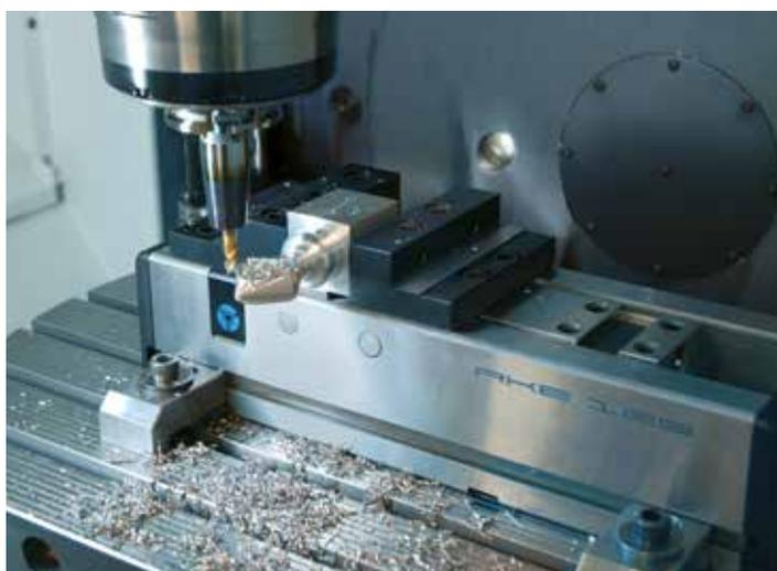
ROEHM社のNCコンパクトバイスは、単一生産、マスプロダクションを問わずあらゆる生産アプリケーションにフィットします。多彩なタイプと構造、サイズバリエーションにより、いかなるワークエリア、ワーク、マシン作業にも適正な作業環境を実現可能にしております。
