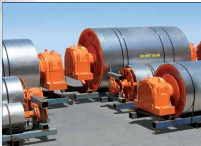
Versandfertige Bandtrommeln mit Spannsätzen /
