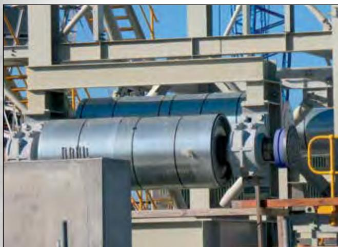
Bandtrommel mit Spansätzen und einer Schrumpfscheibe auf der Antriebsseite
