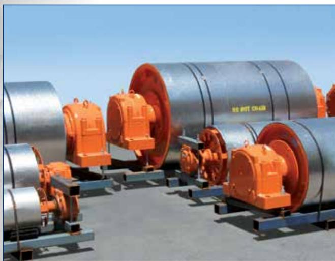
Versandfertige Bandtrommeln mit Spannsätzen /
