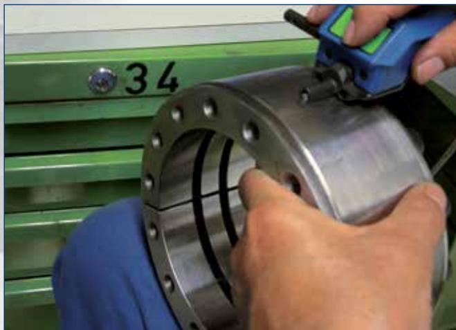
Rauheitsmessung / 表面粗さ測定
