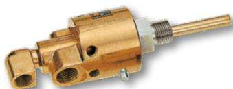
種々の媒体、特に水とサーマルオイル用の汎用ロータリージョイント。バランス型メカニカルシールとボールベアリング使用で回転負荷軽減。使用媒体によりシーリング材を選択できます。印刷産業、プラスチック産業、PP製コンベアベルトには特に最適。
