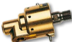
冷水、温水用ロータリージョイント。メカニカルシールとボールベアリングで回転負荷対応。DXS型はシール面が耐摩耗性の高いセラミックでコーティングされています。
