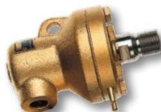
メンテナンスフリーのカーボンシールリングとカーボンブッシュを使用した、汎用性の高いロータリージョイント。サーマルオイル及び、高圧の熱水・スチームにはメタル含浸シールリングを使用。H3型はスチームシリンダーに負圧安全バルブを装備しています。
