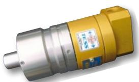
工作機械での高速回転対応の高性能ロータリージョイント。回転しているマシンへ冷却剤、グリース、エアを供給。TESSシステムはドライ運転に最適、ピーク圧時にも対応します。ローター16000rpm,ハウジング24000、42000rpm対応。最大150 bar。国際特許取得。
